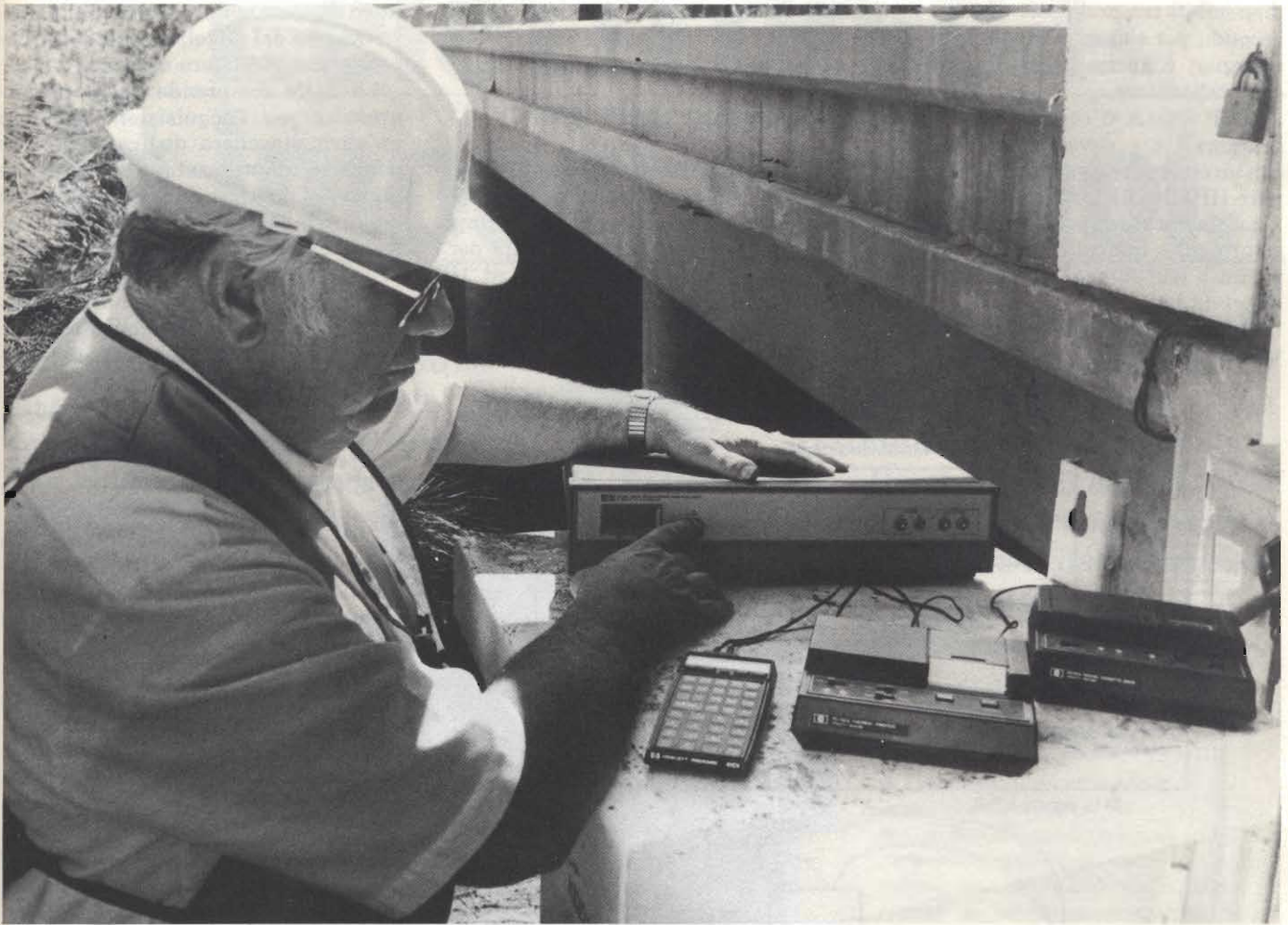
Sistema di acquisizione dati e controllo HP3421A impiegato per misurare la temperatura di varie sezioni di un ponte allo scopo di determinare il momento più adatto per la ripavimentazione del ponte stesso. Nello stesso tempo è possibile misurare le eventuali deformazioni delle travi annegate nel calcestruzzo allo scopo di prevedere la durata del ponte.
