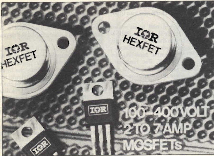
MOS di potenza della International Rectifier. Si tratta di FET/MOS di media potenza che possono trattare da 2 a 7 A con tensioni da 100 a 400 V. La tecnologia HEXFET, introdotta dalla I.R. consente a questi dispositivi di essere in prima fila tra i MOS di potenza attualmente sul mercato.
