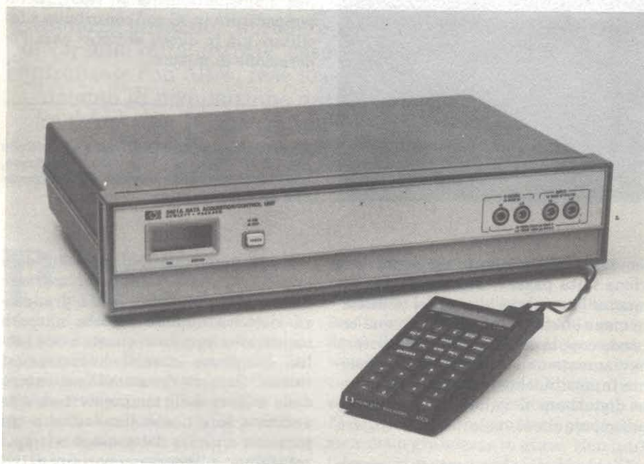
Fig. 4 - Il sistema di misura e di acquisizione di dati HP 3421A è comandato dal calcolatore tascabile HP-41CV. Questo sistema è completamente programmabile e deve essere utilizzato con un computer compatibile con le interfacce HP-IL o HP-IB (IEEE-488). L'interfaccia HP-IL è standard. A richiesta è possibile avere sia l'HP-IL sia l'HP-IB. Un commutatore posto sul pannello posteriore permette all'utilizzatore di effettuare la scelta tra le due interfacce.
