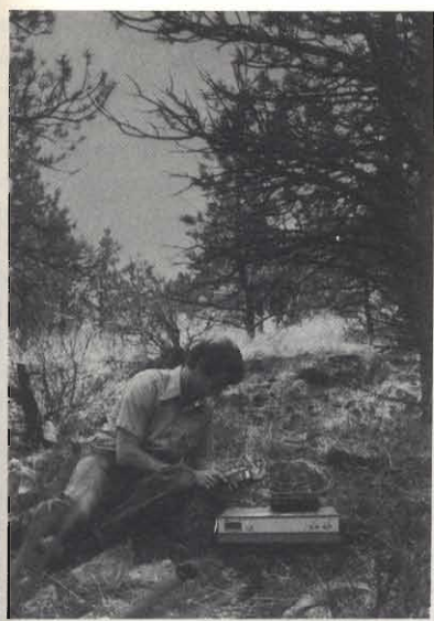
◀ Misura della temperatura del suolo in 30 punti differenti (postazioni) allo scopo di studiare in quale misura il disboscamento può ripercuotersi sulla mortalità dei giovani alberi rimasti nella foresta.
